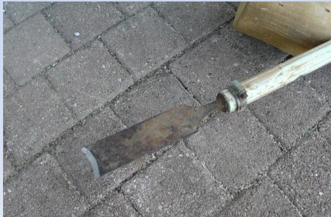
Für die vordere Schlauchklemme sollte eine kleine Vertiefung eingeraspelt werden, damit sie nicht verrutscht.
